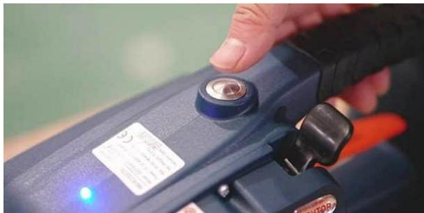
4. Verschweißhebel drücken. Die Bänder werden verschweißt und Band wird abgeschnitten. Abwarten bis LDE nicht mehr blinkt.
