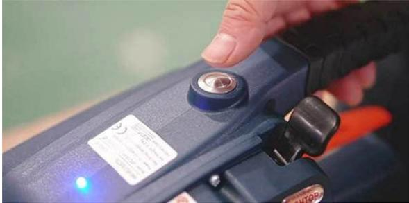
2. Band um Paket umwickeln, Bandanfang unten, überlappend. Rote Hebel hochziehen und beide Bänder einführen.
